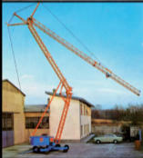
La gru Dalla Serie 316 REC (1970) è stata un esempio di robustezza, semplicità ed economicità. Il progetto è derivato dall'ambizioso modello 316 che non riusciva a imporsi sul mercato perché troppo costoso. Completamente riprogettata mantenendo inalterate le prestazioni, la 316 REC divenne un «best seller» assoluto con migliaia di esemplari venduti.
